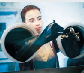
Präparation elektrochemischer Materialien in einer Glovebox. (Foto: Jan Hosan)
